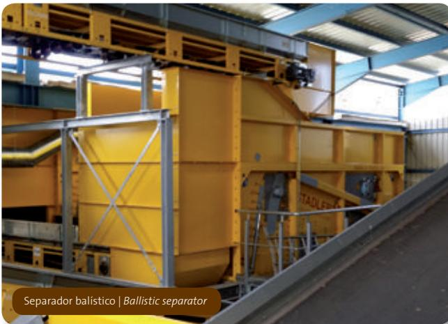
Separador balístico | Ballistic separator
