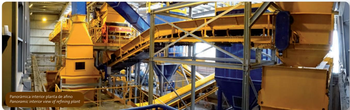
ser recuperados para valorizar y el resto debe remitirse a vertido. Para esta selección se ha instalado una planta de afino del material.
